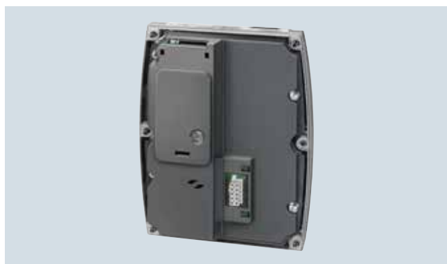
Управляющий модуль, вид сзади, слот для карт памяти сверху, интерфейс PM-IF по центру внизу
