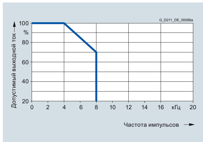
Выходной ток в зависимости от частоты импульсов
