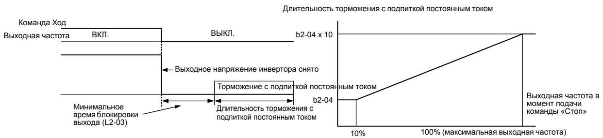
Рис. 6.18 Торможение с подпиткой постоянным током до остановки
